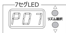
リズム選択ボタンを使って7セグLEDにパターン「P07」を表示させます。
