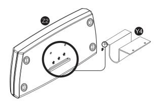
サウンドモジュールを、上から2番目の水平バーに取り付けます。U字ブラケット**愛**を水平バーを挟むように回転させます。
