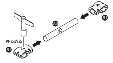
40cm バー (太) №に T 字ジョイント (大) ⑤を通した後、P6 で組み上げた 30cm バー (太) ⑥を通し両端にフロアストッパー⑥を差し込みます。組んだパーツは次の STEP2 で使用します。
