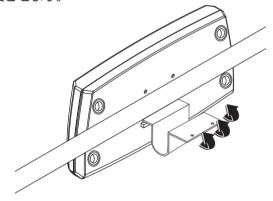
プラスドライバーでネジ2箇所を固定し、前面パネルが見えるように位置調節します。
